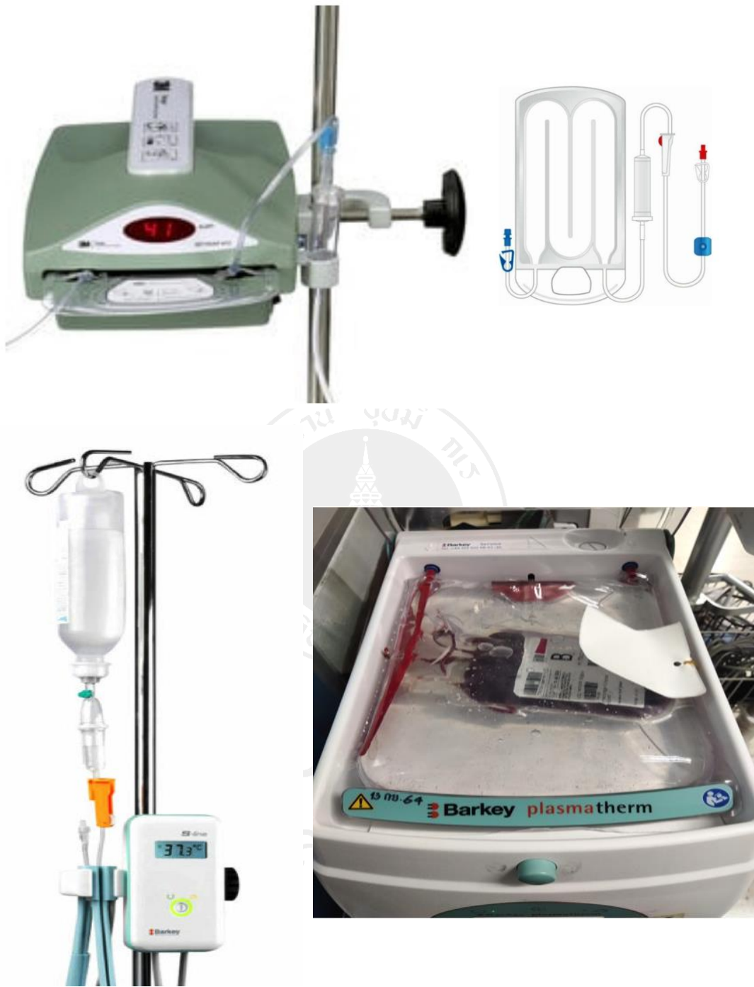
รูปที่ 7 Ranger™ Blood/Fluid Warming Unit และ Ranger disposable set (บน) Barkey S-Line (ล่างซ้าย) Barkey plasmatherm (ล่างขวา)
