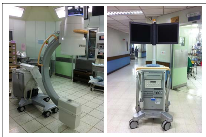
ภาพที่ 11 แสดงเครื่องเอ็กซเรย์ C-arm ชนิดเคลื่อนที่ (ซ้าย) และจอแสดงผลภาพ (ขวา)
