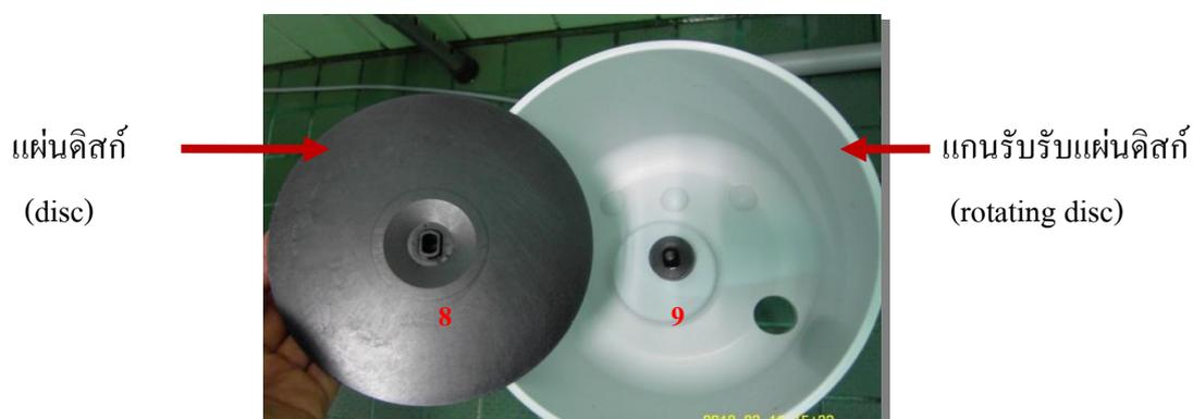
ภาพที่ 13 แผ่นดิสก์ (disc) และแกนรองรับแผ่นดิสก์ (rotating disc)
