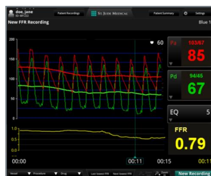
ภาพที่ 11 แสดงหลักการวัดค่า FFR (fractional flow reserve)
