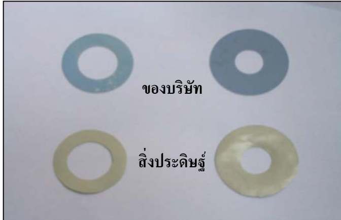
รูปภาพเปรียบเทียบ Disk Membrane และ Intake Membrane ระหว่างของบริษัทกับของที่ประดิษฐ์ขึ้นเอง จาก Inner Cuff NIBP
