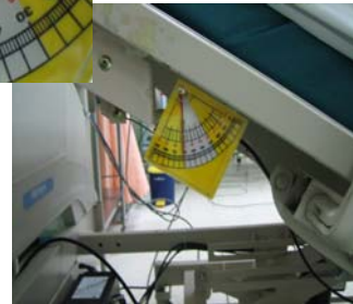
รูปที่ 4 และ 5 แสดงการปรับระดับเตียงให้อยู่ระดับ 30 องศา โดยใช้อุปกรณ์วัดองศาเพียง
