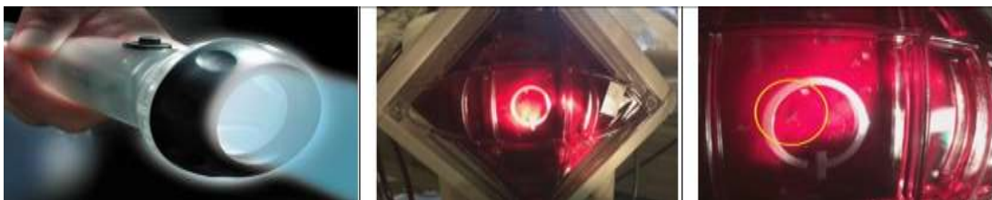
รูปที่ 15 การตรวจสอบการอุดตันของเครื่องกำเนิดออกซิเจน โดยการส่องไฟ
