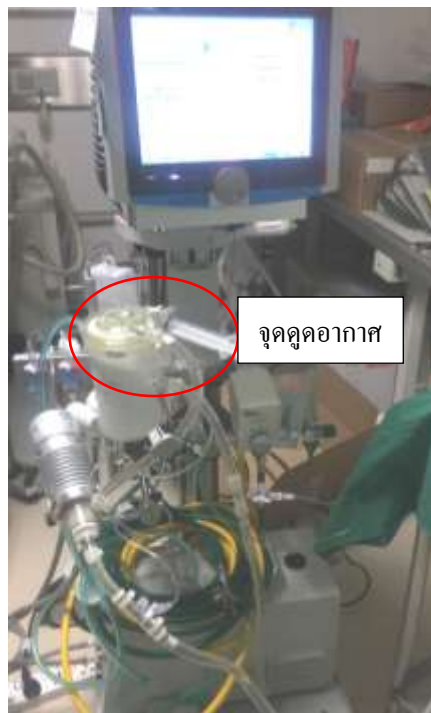
รูปที่ 18 วิธีการดูดอากาศออกจากเครื่องกำเนิดออกซิเจน
